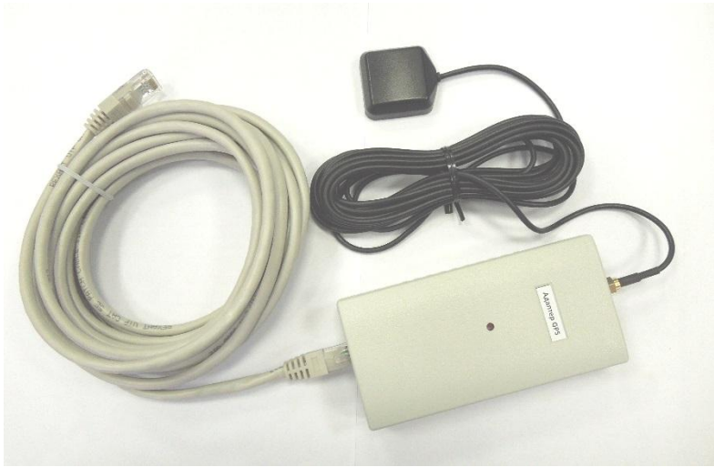
Рис. 17. Внешний вид приемникаGLONASS/GPS «ПСТВ-1»с антенной
